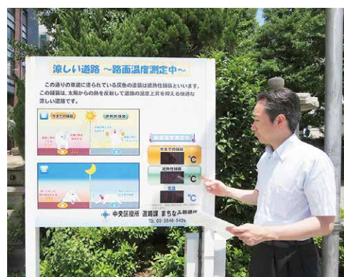
路面温度表示版を設置し、遮熱性舗装と一般のアスファルト舗装の路面温度をリアルタイムで表示しています。
